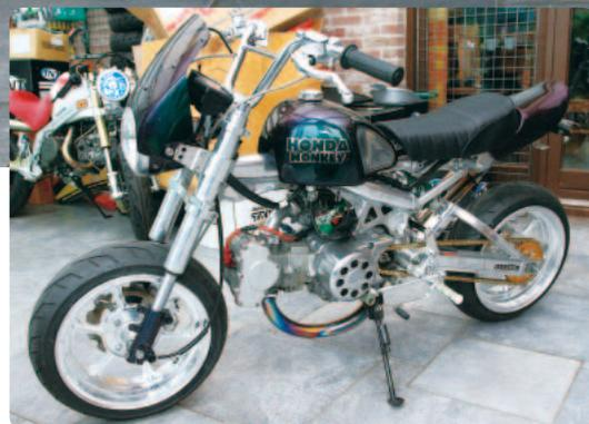
いくらユーロが強いと言っても、ここまでヤレば相当な金額となるだろうヘビー級カスタム。アルミ製タンクにはHONDA MONKEYとペイントされるが、クランクケース以外はモンキーのオリジナルパーツは皆無という内容。フレームの骨格やホイールベース、車高に合わせた前後12インチ化や質感の高い倒立フォークのチョイスなど、全体のバランスも極上。主な装着パーツはOVERレーシング製のアルミフレームとスイングアームに、デイトナ製フロントフォークやSP武川DOHCヘッドなどが搭載されたヘビー級カスタム。前後足周りはプラトーン製削り出しアルミ製ホイール(12インチ)にファルコン製の65扁平タイヤ、T WAY製マフラー、TMR28φキャブレターなど。
