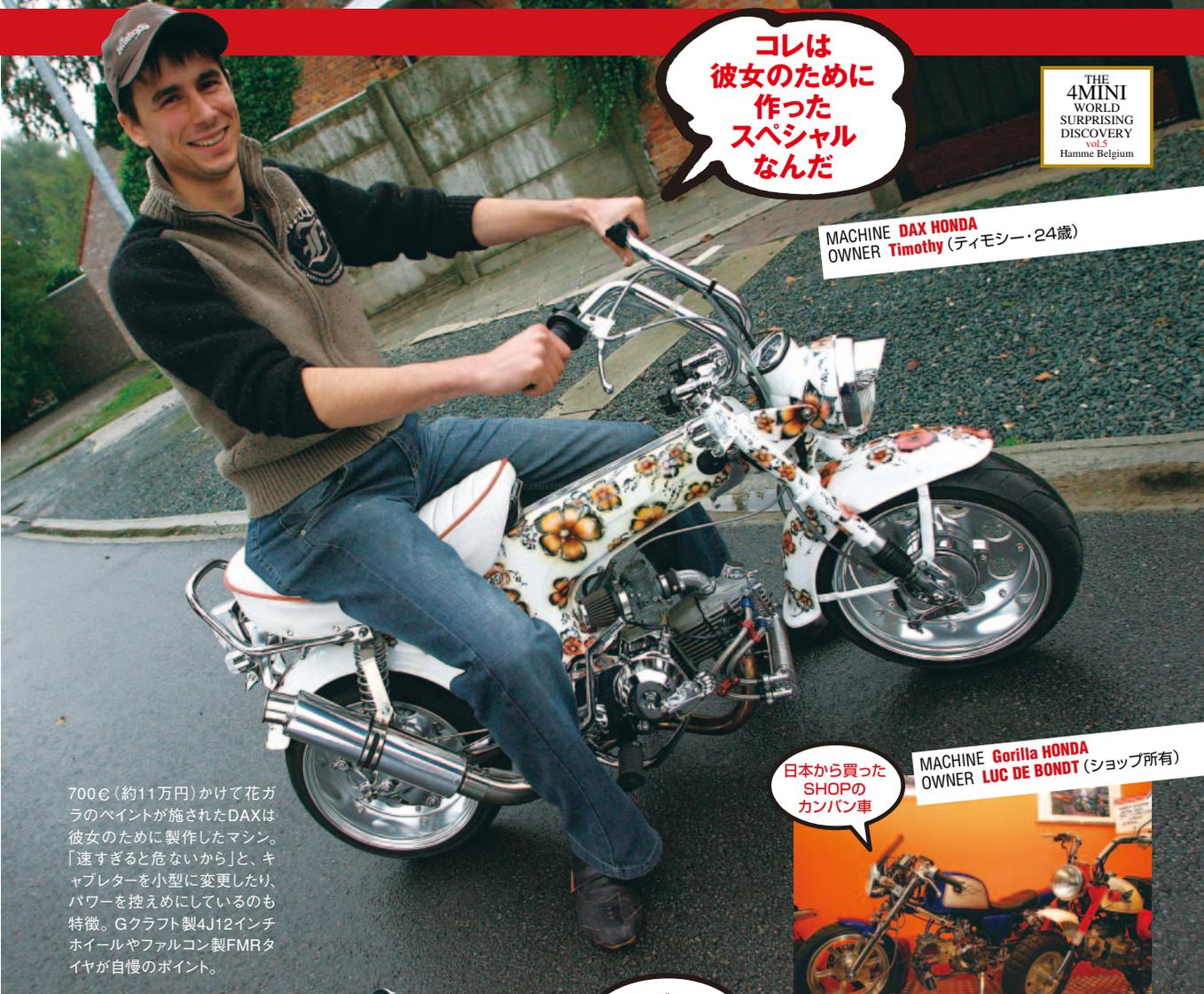
700€(約11万円)かけて花ガラのペイントが施されたDAXは彼女のために製作したマシン。「速すぎると危ないから」と、キャブレターを小型に変更したり、パワーを控えめにしているのも特徴。Gクラフト製4J12インチホイールやファルコン製FMRタイヤが自慢のポイント。
