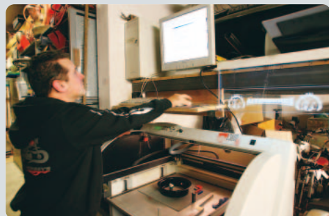
▲ブROOMさん自慢の最新機器がコレ。レーザーを使用してホイールなどに細かな刻印を彫っていく機械です。自慢の機器だけあって、実演してくれちゃいました。
