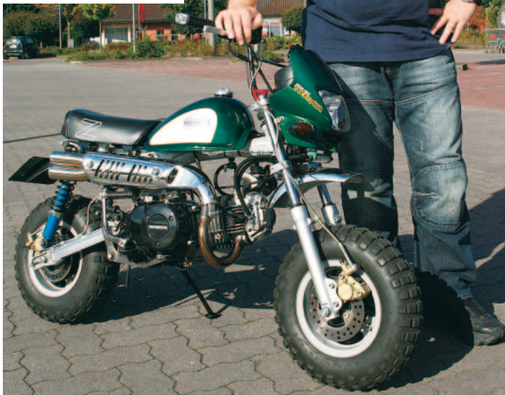
ナイス110のエンジンを搭載し、176cc化してSP武川製スーパーヘッド+Rを装着。ドイツ製マフラーを自作加工して装着し、前後ディスクや27φのテレスコピックフォークで走りもバッチリ!
