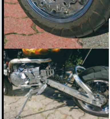
▲モノサス仕様のスイングアームや左側面に取り回されるステンレス製エキパイはバフがけされ、メッキ仕上げのクラックケースカバーやアルミ製のバックステップなどと統一感のある質感を作り上げている。リヤタイヤはリアナ145/50-10サイズ。
