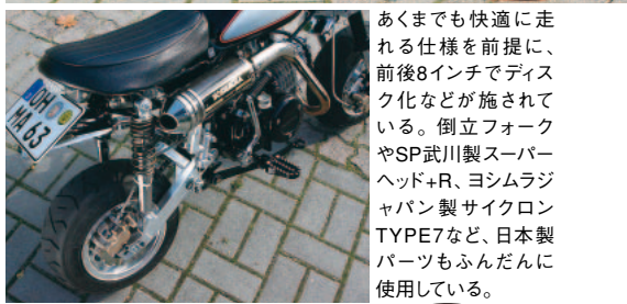
ナイス110のエンジンを搭載し、176cc化してSP武川製スーパーヘッド+Rを装着。ドイツ製マフラーを自作加工して装着し、前後ディスクや27φのテレスコピックフォークで走りもバッチリ!
