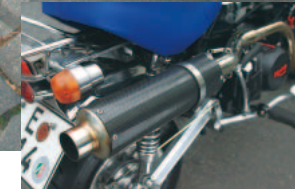
▲カーボンサイレンサーが外見を引き締めるキタコ製ステンアップマフラーを採用。
