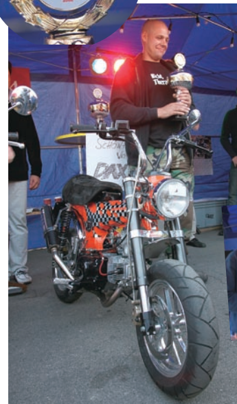
◀2位にはドイツのRene Denti(39歳)が入賞。ゲイルスピード(ホイール)やOVERレーシング製マフラー、SP武川製ヘッドやWPの倒立フォークなど、走りも意識したアイデアタップリな仕上がりになりました。
